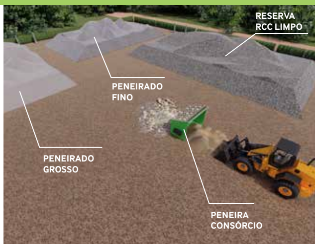
Figura 7 – Desenho ilustrativo da Área de Manejo de Resíduos da Construção Civil.
