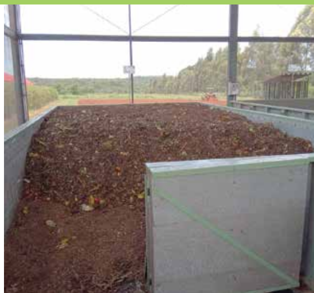
Foto 21 - Pilha Estática de compostagem com aeração forçada.
