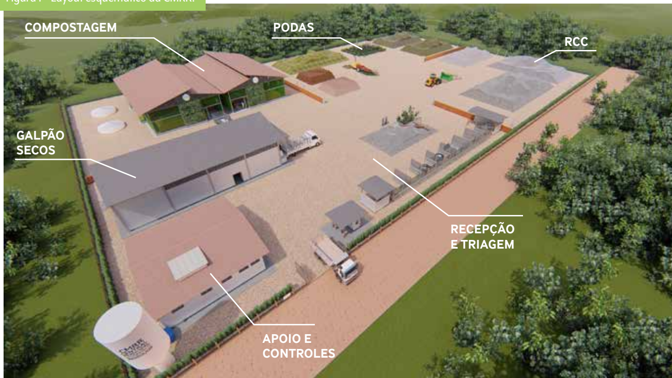
Figura 1 – Layout esquemático da CMRR.
