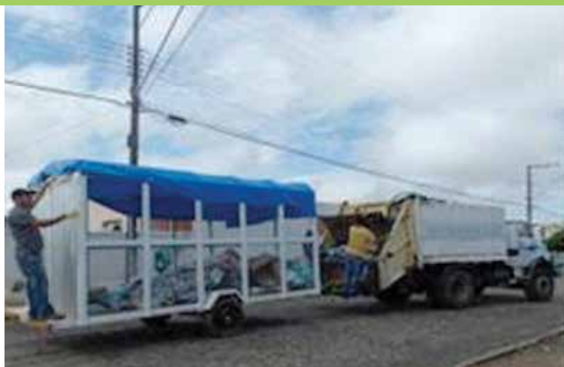
Foto 24 - Carreta simples para o transporte de resíduos orgânicos segregados, acoplada a veículo de coleta.
