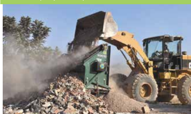
Foto 23 - Operação com a peneira vibratória.
