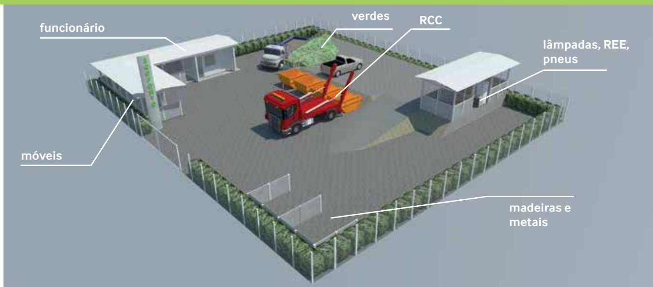
Figura 2 – Layout esquemático do Ecoponto Padrão – área entre 800 e 1.000 m 2 com operação de caminhão políguas.
